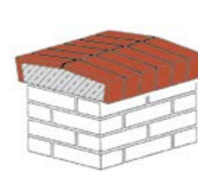
Mauerwerks-Abdeckung mit durchgehender Mittelfuge.
