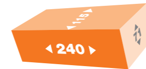
NF Normalformat 240 x 115 x 71 mm
